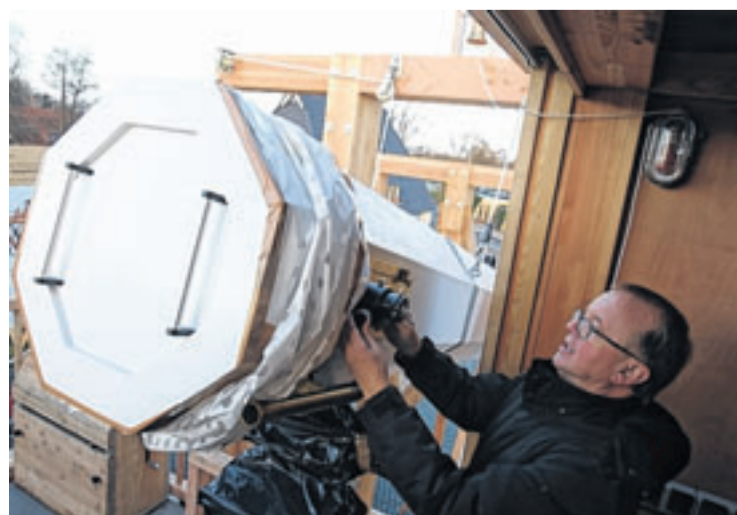
Das Fernrohr wird über eine gabelartige Holzkonstruktion ausgerichtet, die auf einem gemauerten Turm ruht. Das Gerät mit dem Tubus lässt sich horizontal um die Mittelachse des Turmes drehen.
